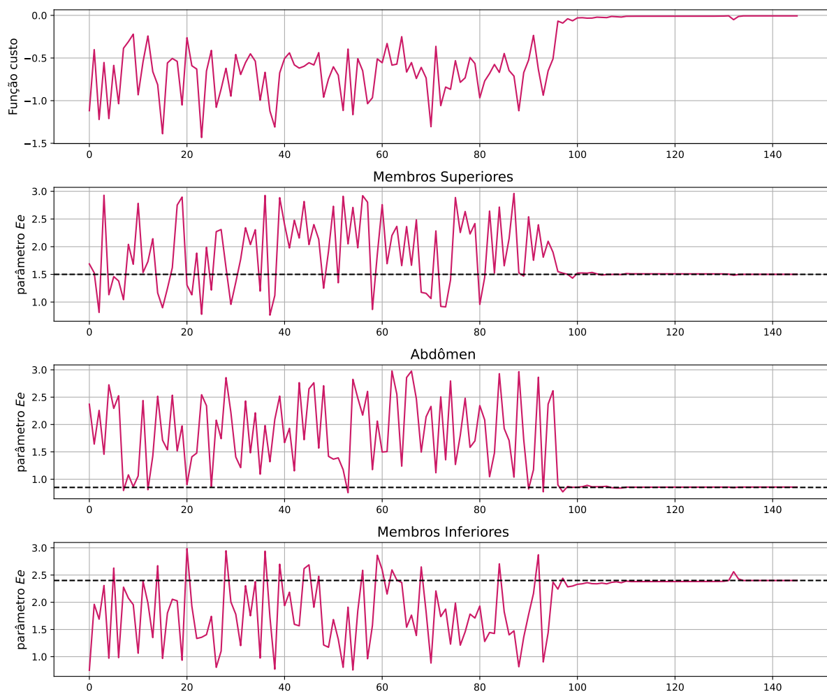
Figura 51 – Comportamento do parâmetro E_e nas regiões dos membros superiores, abdômen e dos membros inferiores e da função custo ao longo das iterações.
